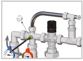
É possibile intervenire e modifcare la taratura del by-pass con l'utilizzo di una chiave a brugola da 5mm. Per accedere alla vite di regolazione svitare il volantino bianco e inserire la chiave:
